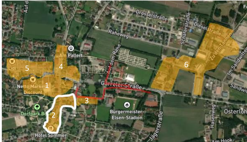
Abbildung 49: Erhalt des Bestandwärmenetzes Ortskern und Erweiterungsoptionen
